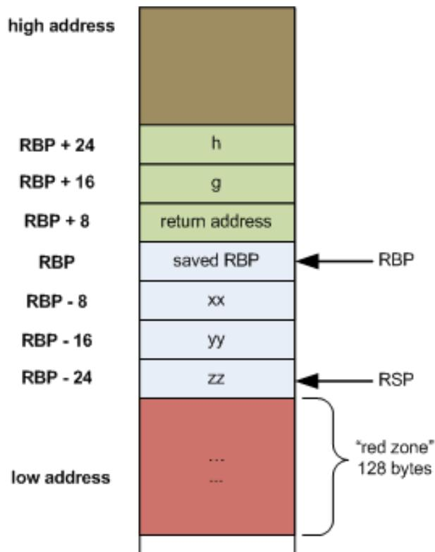
Al crearse el stack frame de una función, una dirección por encima del RBP se guarda lo que se conoce como el return address.
